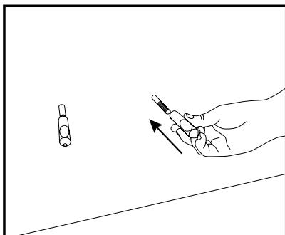
1. Csatlakoztassa a rögzítést a falba rejtett tartály menetes rúdjaira (A felfogatást minden WC szerelőcsomagja tartalmazza). Anchorage rods provided with mounting fittings are attached onto mounting screws.
